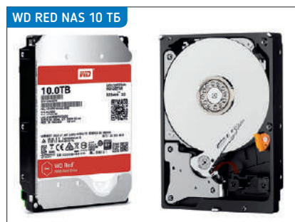
Western Digital упаковала все семь пластин по 1,42 ТБ в гелий-заполненный корпус.
