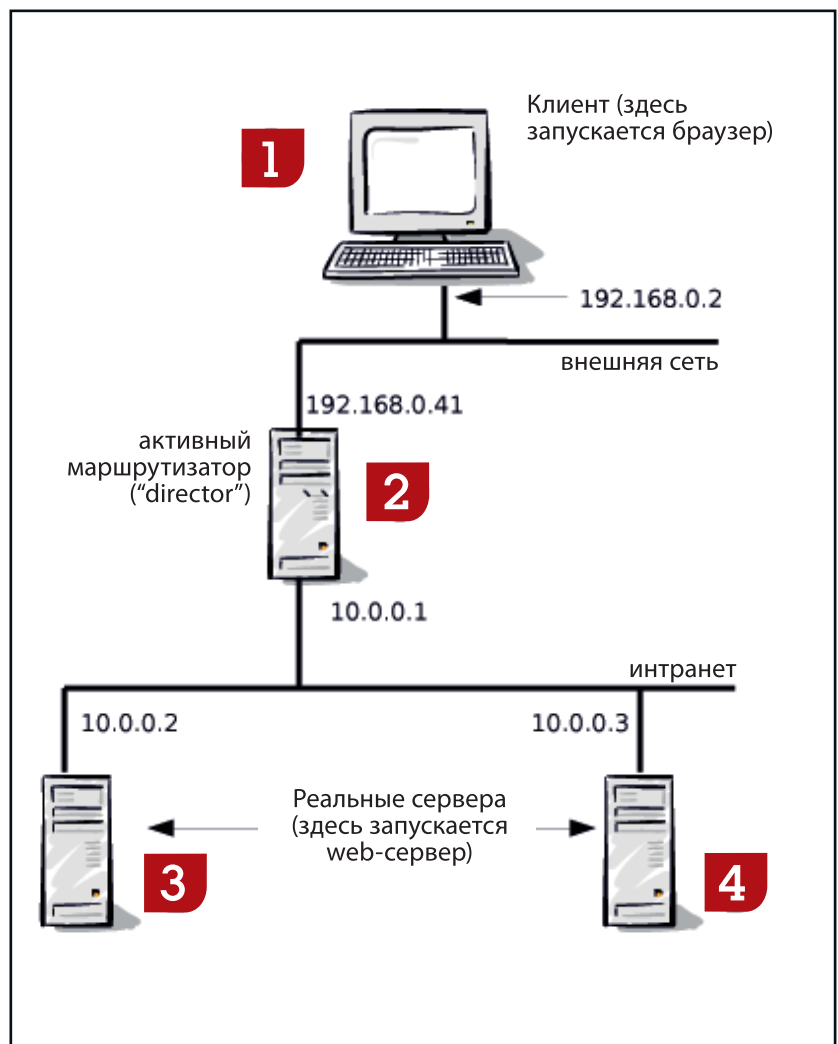
» Рис. 1. Простой кластер со сбалансированной нагрузкой.
