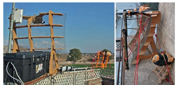
➤ Так выглядят «антенны» передачи данных в сети FabFi. На снимке: две разнесенные на 4 км водонапорные башни с установленными на них передающими устройствами..
