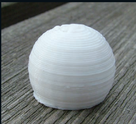
» Если ваш принтер не из самых дорогих, готовые напечатанные 3D-объекты выходят неровными. Неровная поверхность диктует особенности дизайна, которые мы должны применить, чтобы использовать технологию наилучшим образом.
