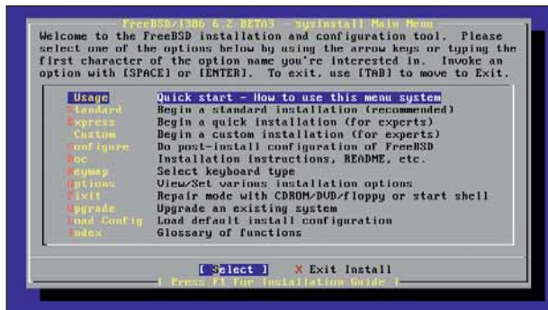
➤ sysinstall , загрузчик FreeBSD, исправно работает, не меняясь годами – но ему не хватает средства разбивки жесткого диска.
