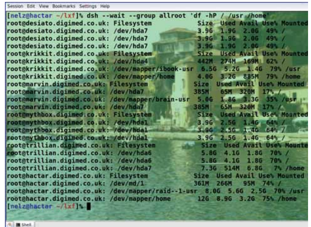
» Dsh запускает команду сразу на нескольких ПК: здесь – проверка использования дисковой памяти в основных разделах через сеть.
