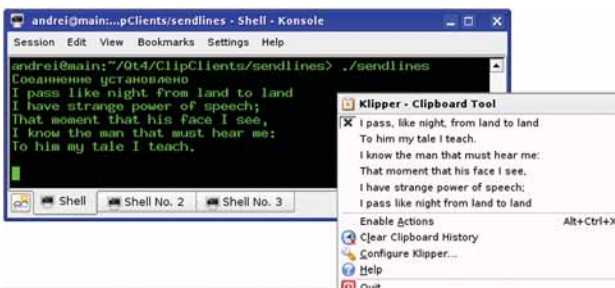
➤ Рис. 2. Базовый клиент D-Bus может передать в буфер обмена сразу несколько строк.
