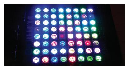
Наш расширенный проект создает многоцветное освещение с помощью Unicorn HAT, используя в коде случайные числа для создания значений.
