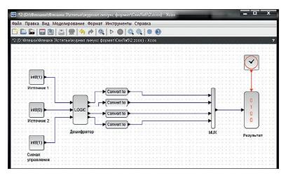
Рис. 7. Модель дешифратора в рабочей области Xcos.
